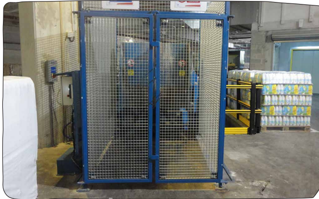
Sécurisation des accès depuis un quai
