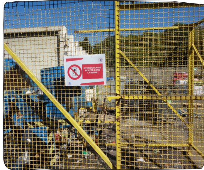
Condamnation physique de l'accès des personnes à la zone de vidage des déchets
