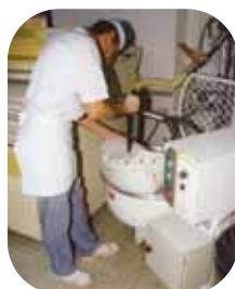
2. Placer le sac, ouverture vers le bas dans la cuve 3. Fendre le fond du sac
