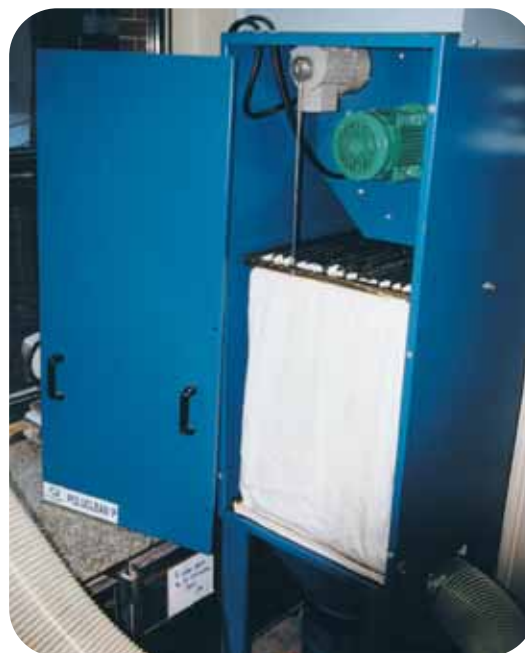
Vue intérieure d'un dépoussiéreur : filtres, vibreur, turbine d'aspiration
