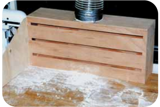
Caisson de captage localisé situé sur la table de travail pour les opérations de fleurage
