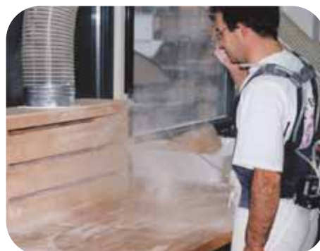
Le fleurage : une opération à fort dégagement de poussières juste sous le nez du boulanger
